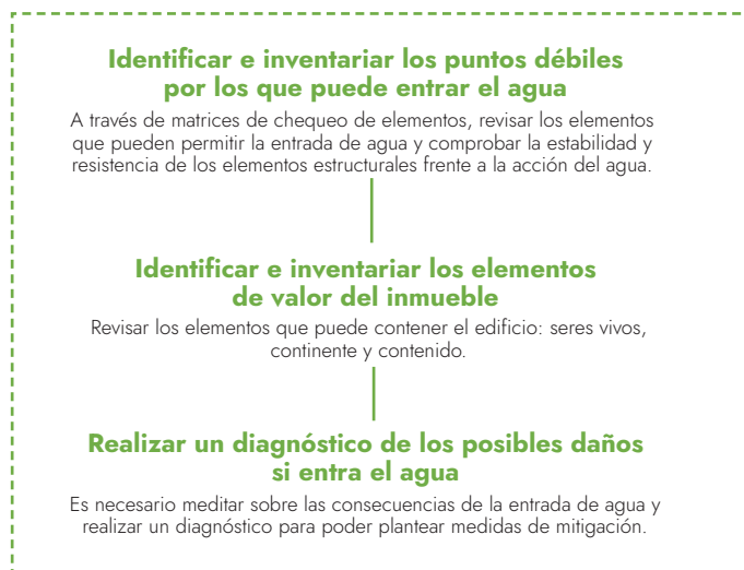
Figura 2. Esquema conceptual de las fases del diagnóstico de daños. Fuente: Consorcio de Compensación de Seguros (2017)
